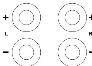
Se l'amplificatore è dotato **solo** di uscite per i diffusori, colleghate i morsetti **HIGH INPUT** del subwoofer all'uscita per altoparlanti dell'amplificatore stesso (in parallelo alle casse) rispettando le polarità ed i canali "L" e "R".
